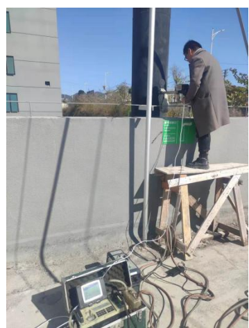
锅炉废气监测
